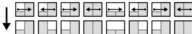
Wir *mergen* die Paare zu bitonischen Folgen der Länge 4. Diese sortieren wir wieder abwechselnd aufsteigend und absteigend. Wir applizieren dazu das rekursive Vergleichsnetzwerk von vorhin:
